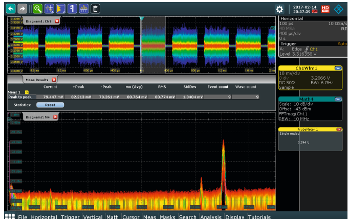
Широкая полоса пропускания пробников шин питания R&S®RT-ZPR позволяет захватывать высокочастотные шумовые компоненты
