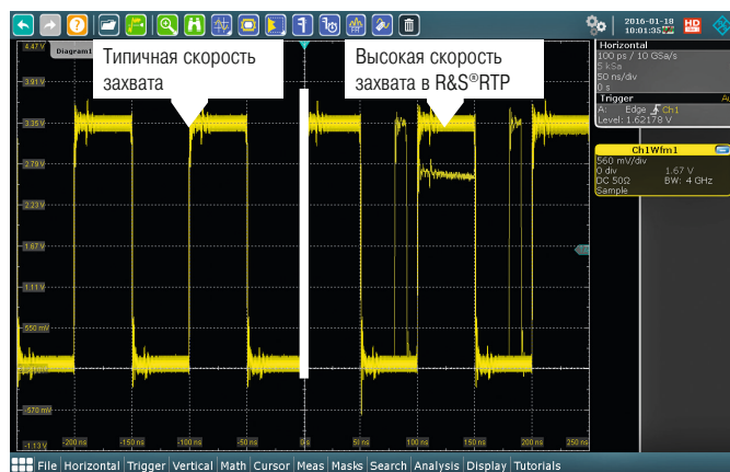
Высокая скорость захвата данных — быстрое обнаружение спорадических сбоев сигнала
