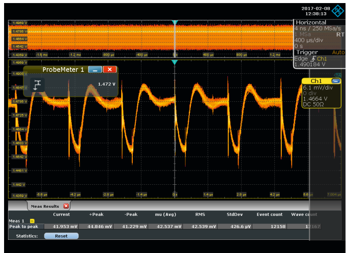
Точная проверка уровня постоянной составляющей и характеристики нагрузки по питанию во время инициализации памяти DDR с помощью пробника шин питания R&S®RT-ZPR и встроенного в него высокоточного вольтметра R&S®ProbeMeter
