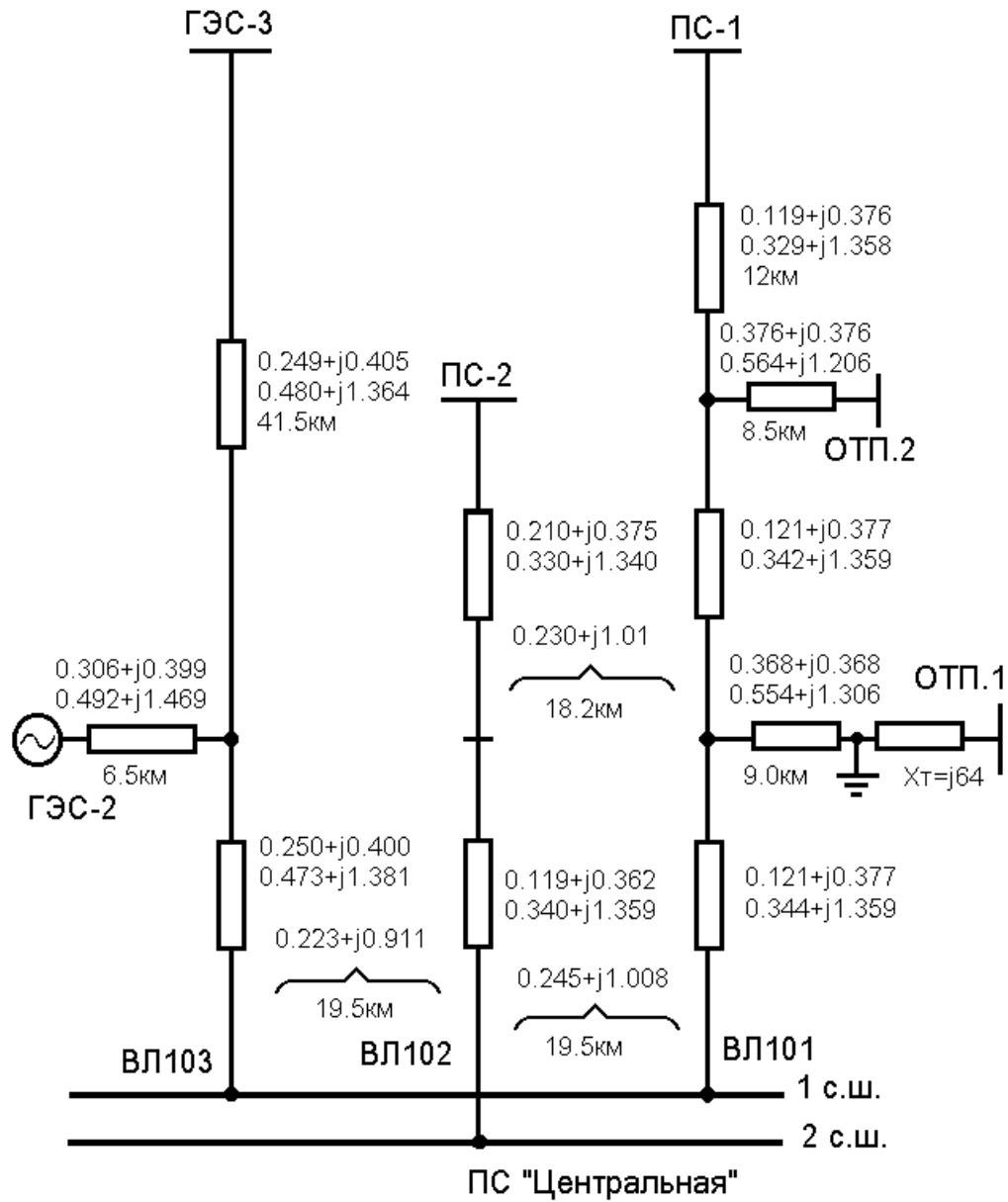
Использование метода одностороннего ОМП на линии ВЛ103 имеет ограничения, так как на этой линии с двухсторонним питанием есть подпитка со стороны ГЭС-2. Поэтому, описывая данную линию, можно указать только первый участок. Метод одностороннего ОМП при КЗ на других участках линии ВЛ103 даст неверный результат.
