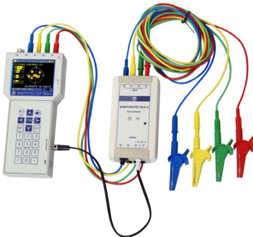
Рис. 3.2а. Подключение Энерготестера к адаптеру универсальному.
