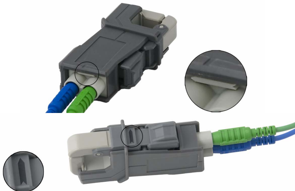
Рисунок А2 Расположение маркировки «генератор → нагрузка» на токоизмерительных клещах 10А и 100А.
