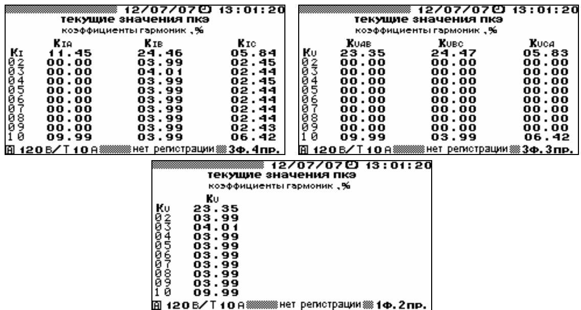
Рис. 4.24. Окна отображения коэффициентов искажения синусоидальности и гармонических составляющих напряжений и токов для различных схем включения
