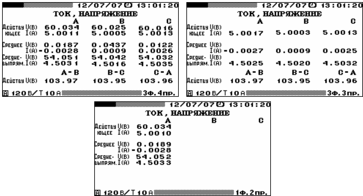
Рис. 4.5. Режим отображения напряжений и токов для различных схем включения
