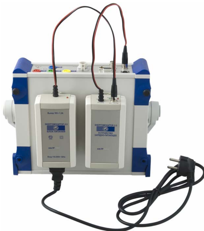
Рис. В.3. Схема включения Прибора ЭМ-3.3Т1 через УЗП и сетевой адаптер
