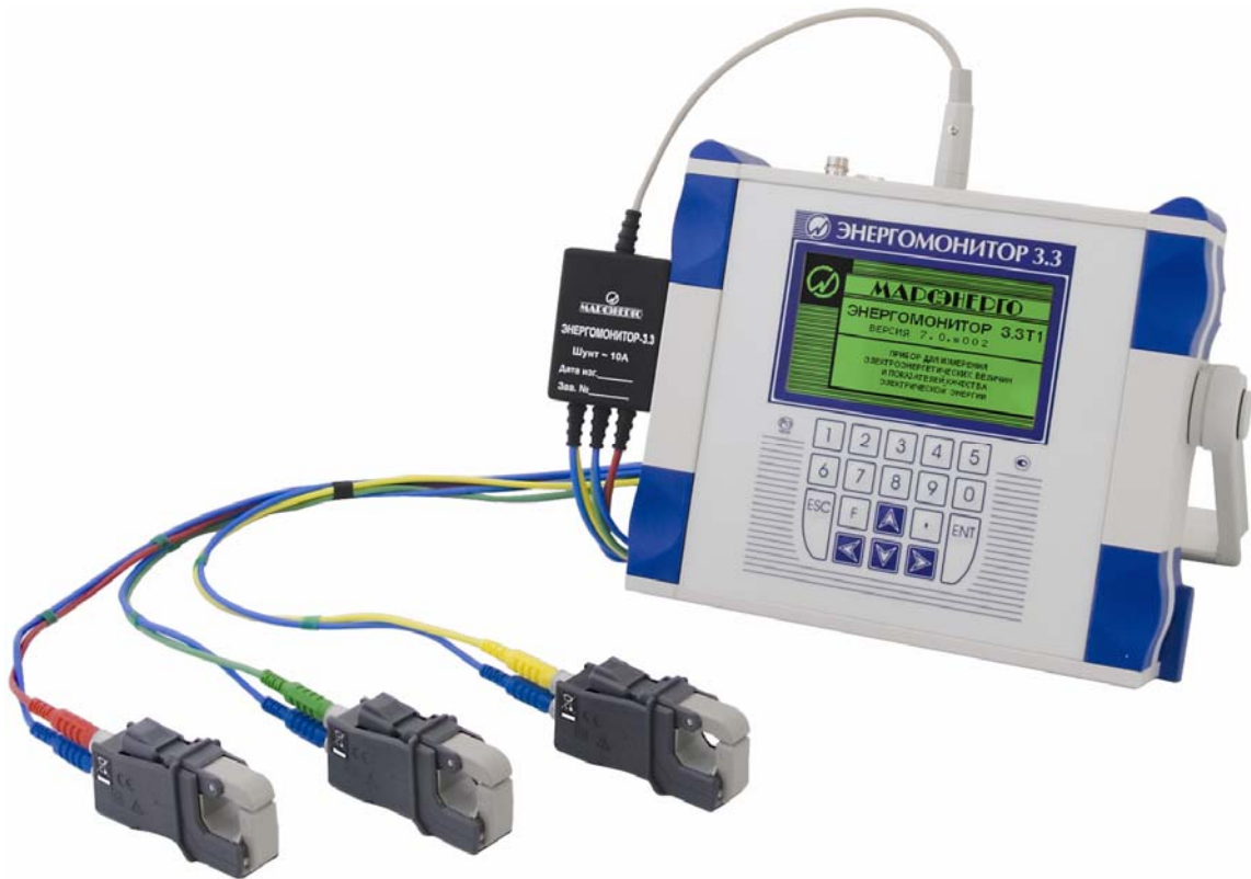
Рис. Б.3. Схемы подключения токоизмерительных клещей 10 А к Прибору ЭМ-3.3Т1 через Шунт 10 А
