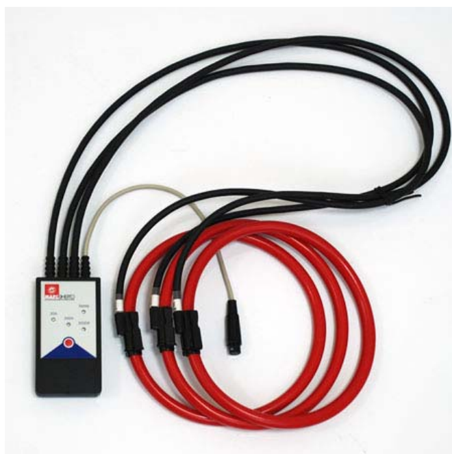
Рис. Б.9. Комплект гибких токоизмерительных клещей на 30/300/3000 А
