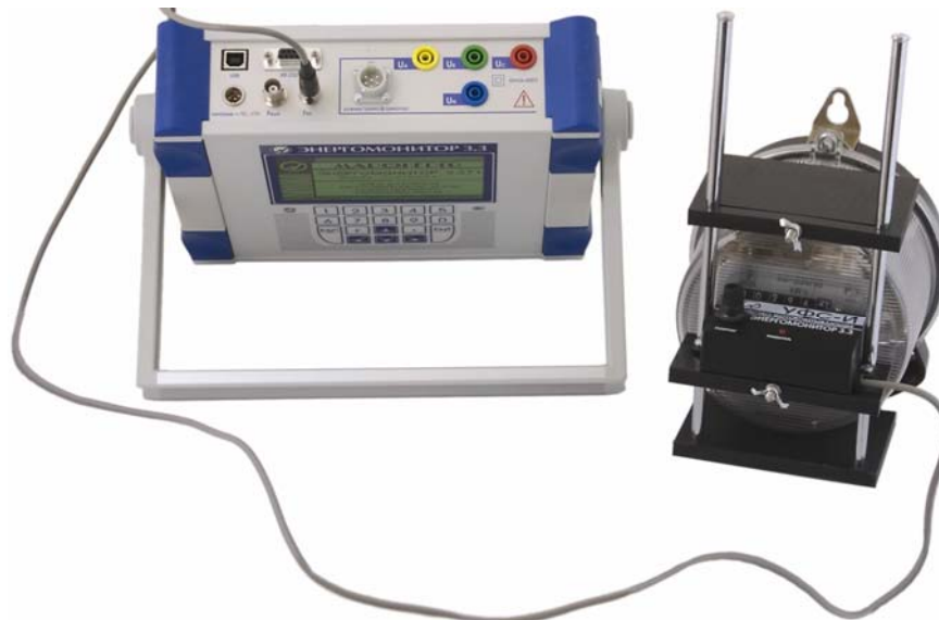
Рис. В.12. Схема подключения Прибора ЭМ-3.3Т1 к поверяемому счетчику индукционного типа через УФС-И
