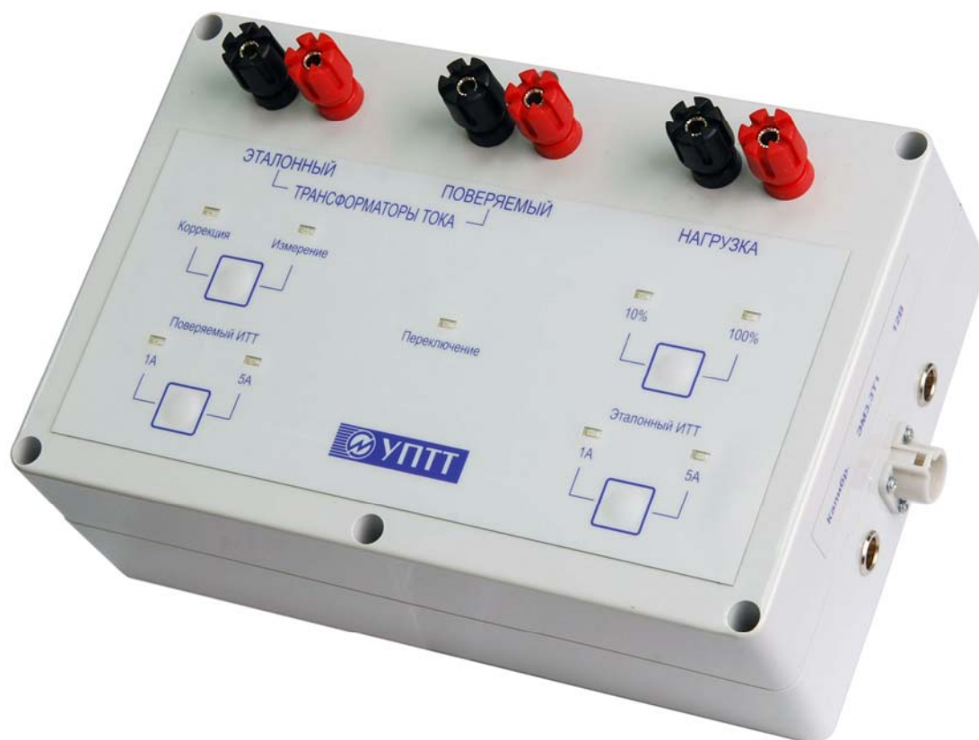
Рис. 4.46. Внешний вид УПТТ на 5 А: разъемы для подключения внешних устройств, органы управления и индикации
