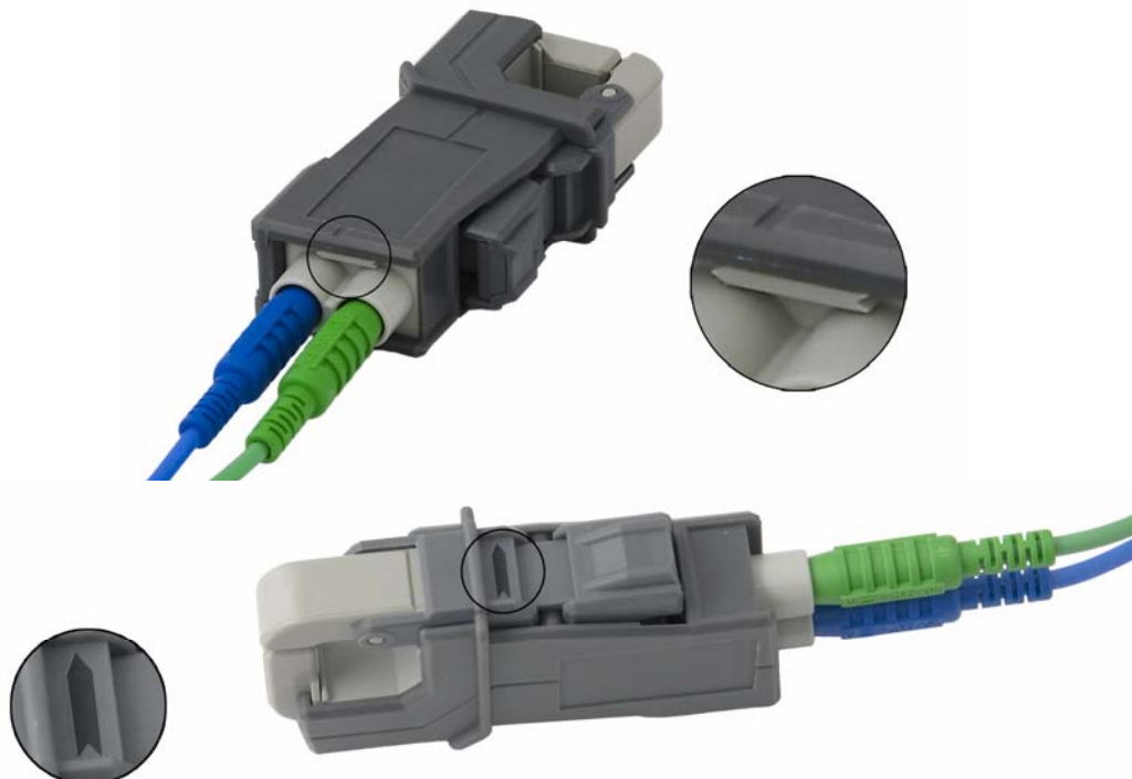
Рис. Б.2. Расположение маркировки «генератор» → «нагрузка» на токоизмерительных клещах 10 А и 100 А
