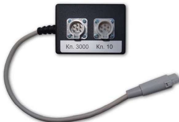
Рис. 4.46а. Блок коммутации «БК 10-3000»
