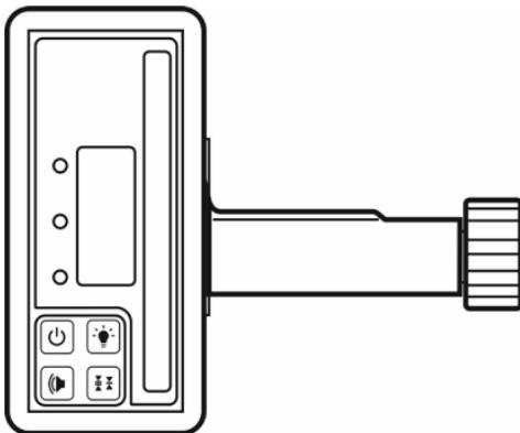
Приёмник улавливает вращающийся луч, когда он пересекает окно электронного датчика.
