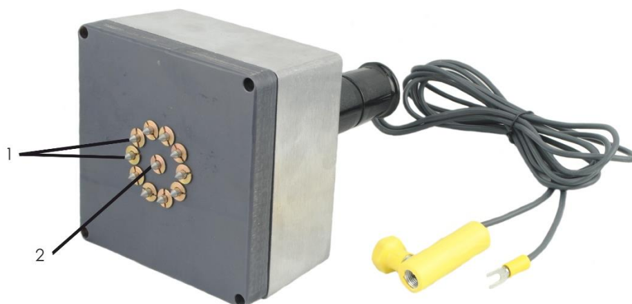
Рис. 5. Датчик для определения УЭС цилиндрических ниппелей 1 – токовые зонды; 2 – потенциальный зонд
