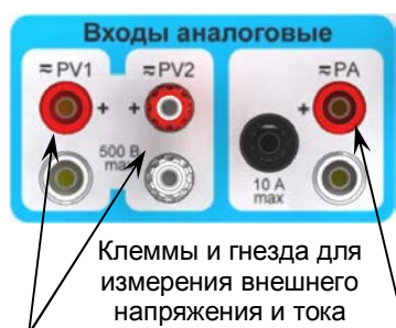
Рисунок 8.3 – Входы аналоговые встроенного цифрового мультиметра
