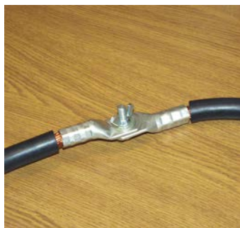
Рисунок Е.3 - Последовательное соединение кабелей
