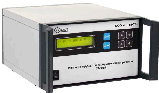
Электронный магазин нагрузок **CA5055** предназначен для воспроизведения нагрузки во вторичных цепях однофазных и трехфазных трансформаторов напряжения (ТН) при их калибровке (проверке, аттестации)
