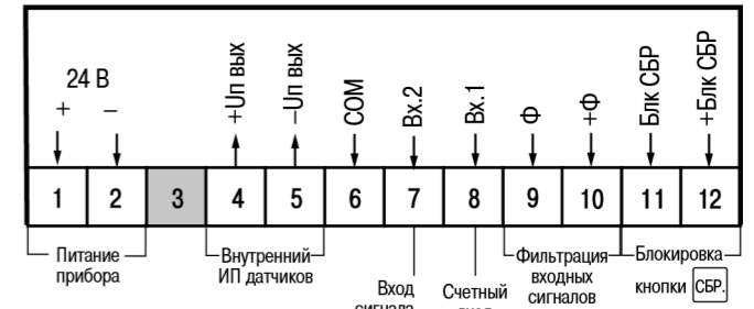
Рисунок 5.1 – Назначение контактов клеммника
