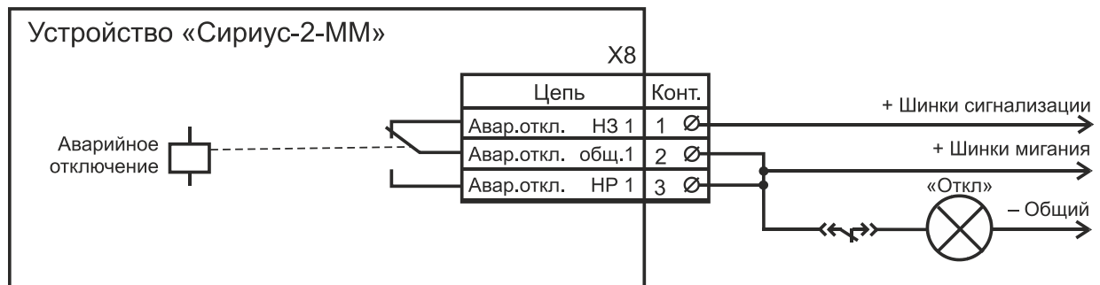
Рисунок Д.3 – Вариант реализации схемы с миганием сигнальной лампочки аварийного отключения устройства с использованием общеподстанционной схемы сигнализации
