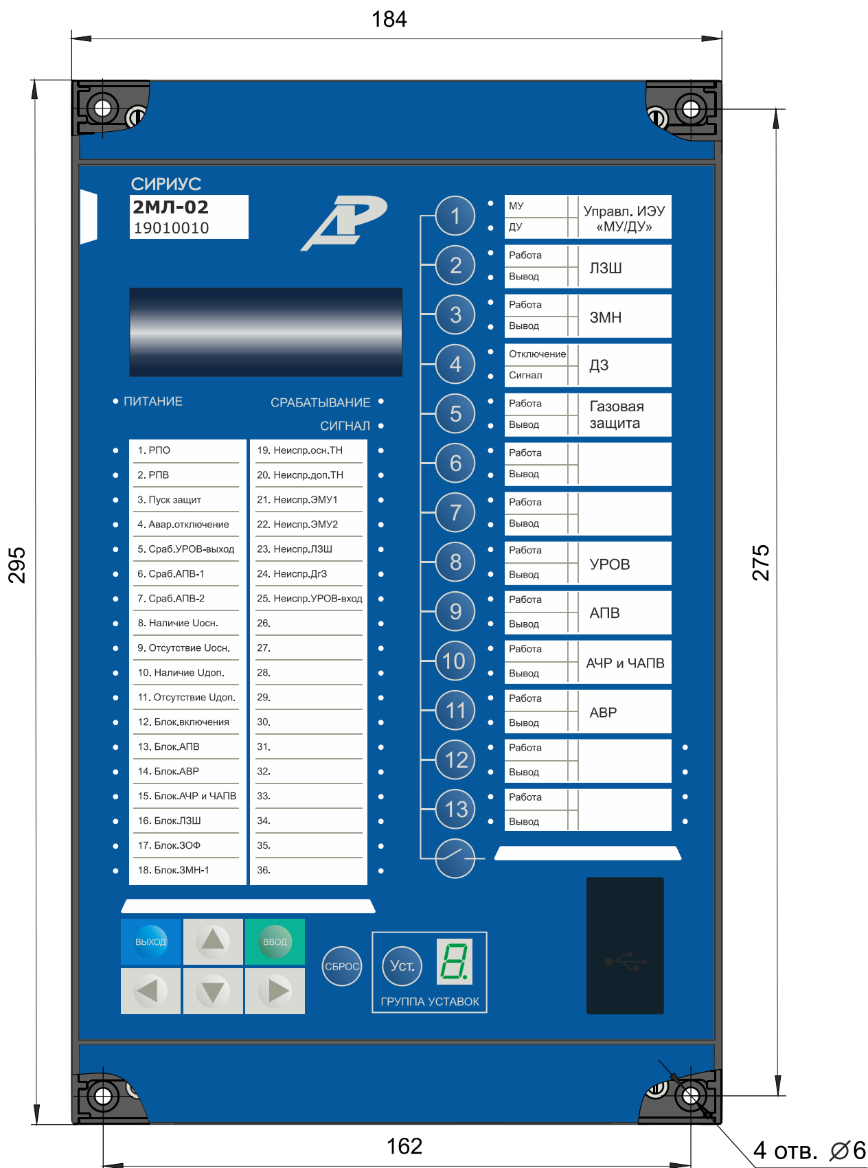
Рисунок А.1 – Вид спереди (лицевая панель LA41) для исполнений K450-41 и K401-41
