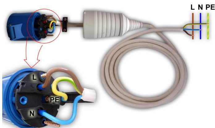
Рисунок 3 – Подключение шнура питания
