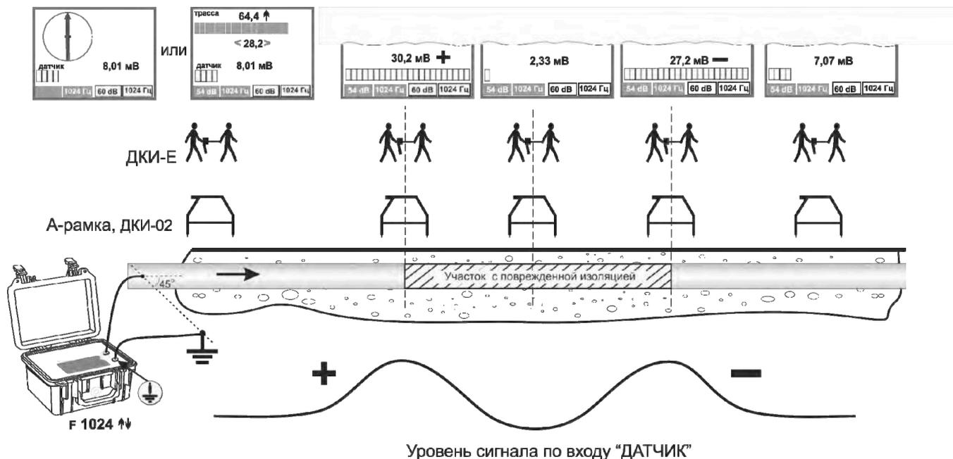
Рисунок 5.2.1 – Схема подключения и уровень сигнала при поиске повреждения изоляции по падению сигнала со сменой знака
