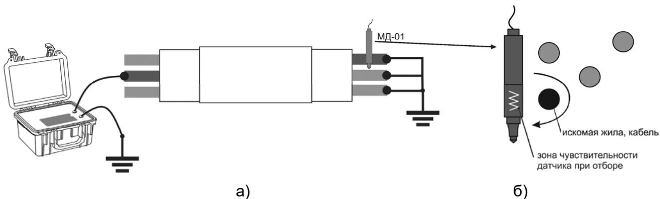
Рисунок 5.4.1 – Схема подключения при отборе жил кабеля
