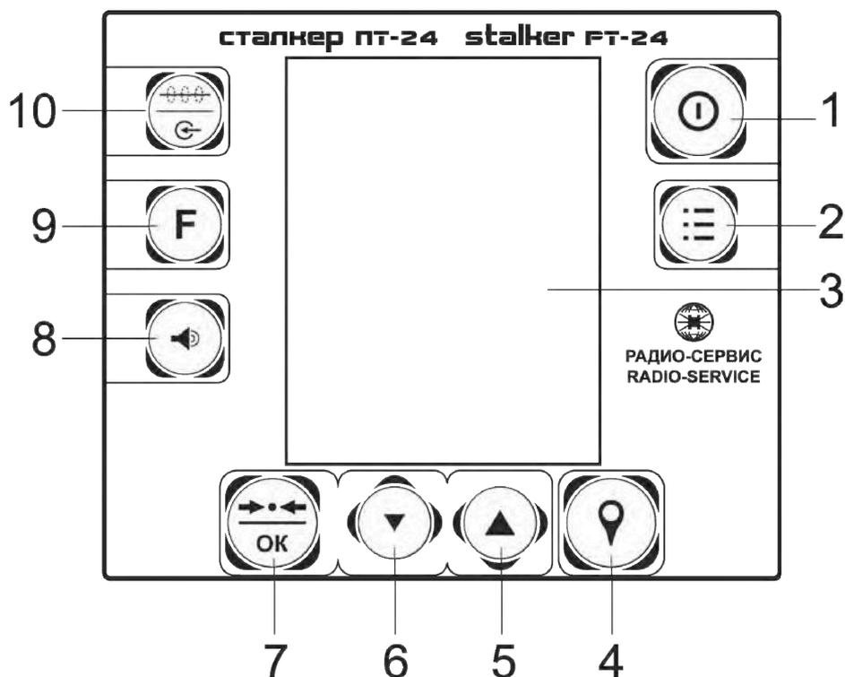
Рисунок 1.4.2 - Передняя панель приёмника
