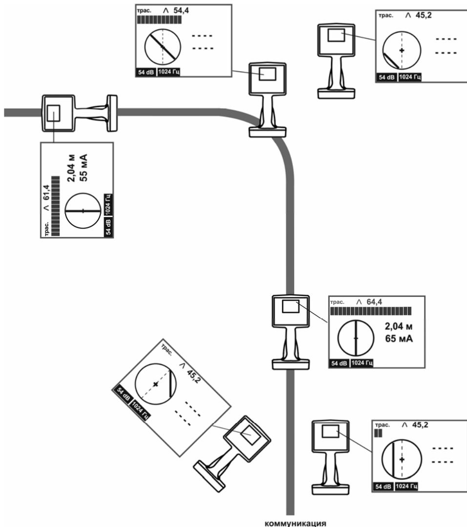
Рисунок 4.2.3а – Поиск с включенной функцией «КОМПАС»
