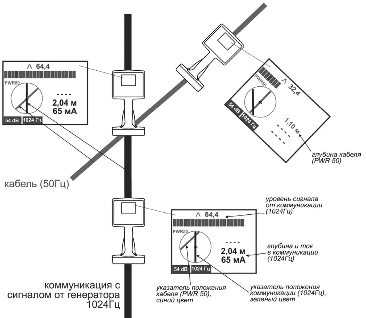
Рисунок 4.2.3б – Поиск с включенной функцией «Вторая линия»
