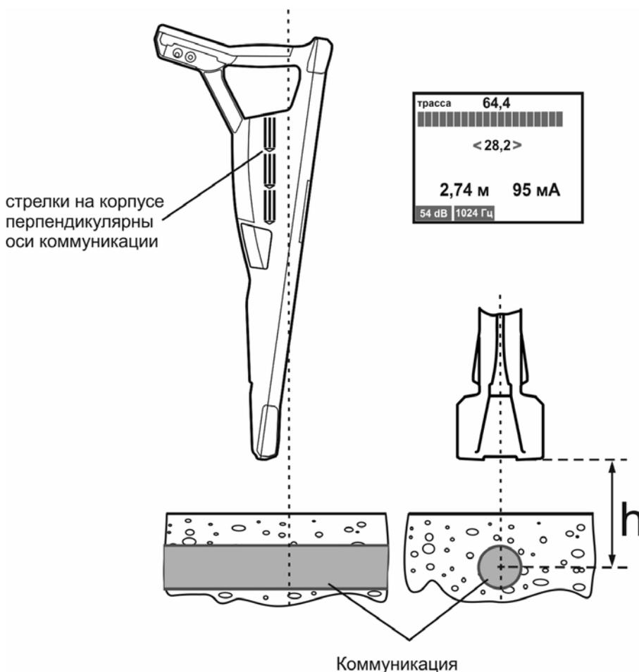
Рисунок 4.3 – Показания глубины залегания и тока
