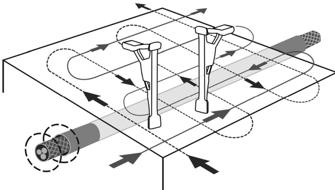
Рисунок 4.4.1 – Обследование участков местности без генератора
