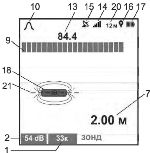
Рисунок 3.4 – Индикация приемника в режиме «ЗОНД»
