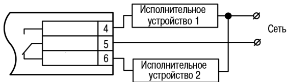
Рисунок 5.3 – Схема подключения нагрузки к ВУ типа Р
