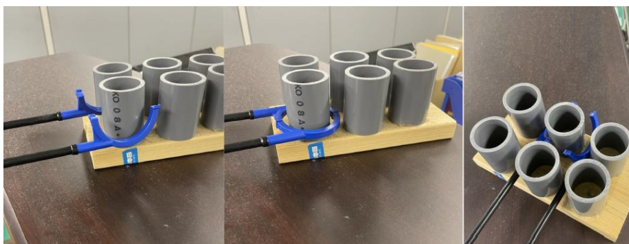
Работа механизма размыкания клещей (ввод зондов к точке измерения тока)
