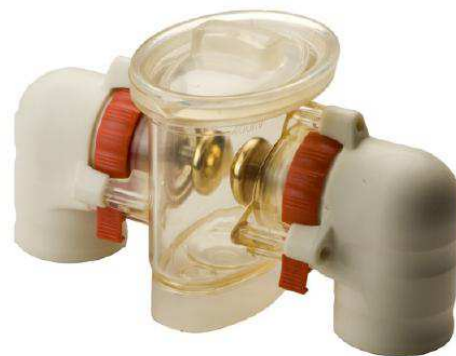
Ячейка объемом 400 мл в сборе (электроды вставлены)
