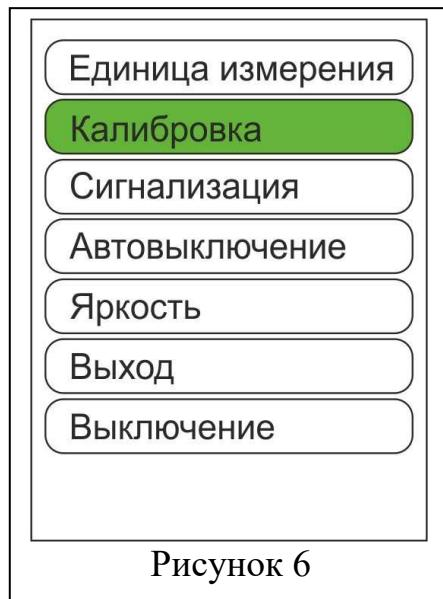
6.6.3 Кнопкой «ВНИЗ» установить подсвеченный маркер на пункт «КАЛИБРОВКА» и нажать кнопку «ОК». Выбрать из появившемся на дисплее окна пункт «УСТАНОВКА 0» и нажать кнопку «ОК» .
