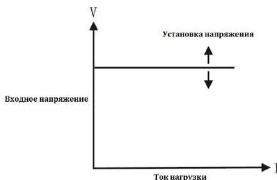
Режим CV имеет дополнительную установку предельного значения тока (CV Curr Limit), при достижении которого нагрузка перейдет в режим CC и продолжит работу без отключения входа.
