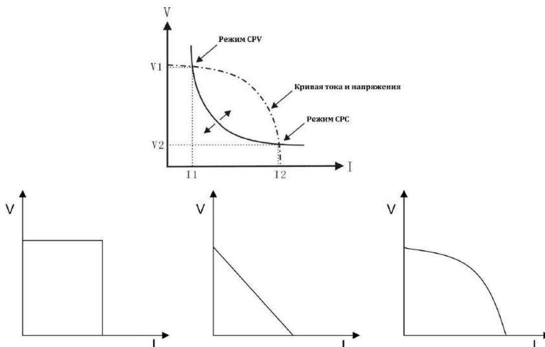
Кривая мощности пересекает кривую тока и напряжения в двух точках (CPV и CPC), когда мощность источника превышает установленные в нагрузке значения. В первом случае происходит за счет роста тока, во втором – напряжения.
