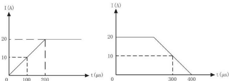
Если тестируемый источник отключается при активации режима с выставленным максимальным током, то следует установить меньшее значение (70-80% от номинала), запустить тест, нажать клавишу I-set (либо нажать на поворотный регулятор), и далее поворотным регулятором плавно повышать ток в процессе работы до требуемого значения.
