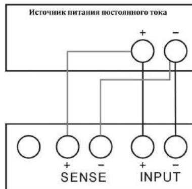
Если при подключении внешнего источника была перепутана полярность, на экране появится индикатор RV, и выход нагрузки будет отключен. После переподключения нажмите и удерживайте Cancel для сброса статуса.
