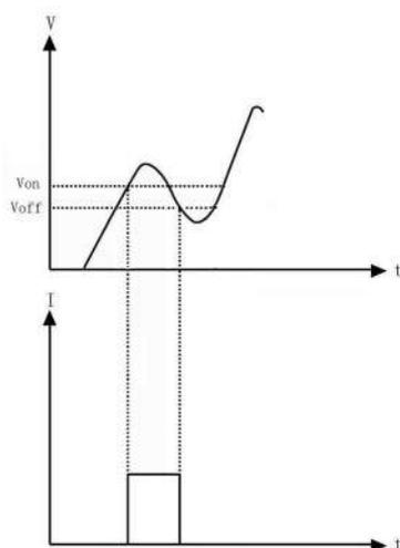
Также можно задать только точку включения ( $V_{on}$  point), после которой режим будет работать непрерывно, независимо от дальнейшего изменения параметров ( $V_{on}$  Latch).
