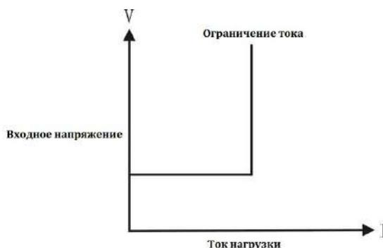
При использовании внешнего триггера, заданное значение напряжения активируется сразу, как появляется управляющий сигнал, при условии включенного режима CV и входа нагрузки.
