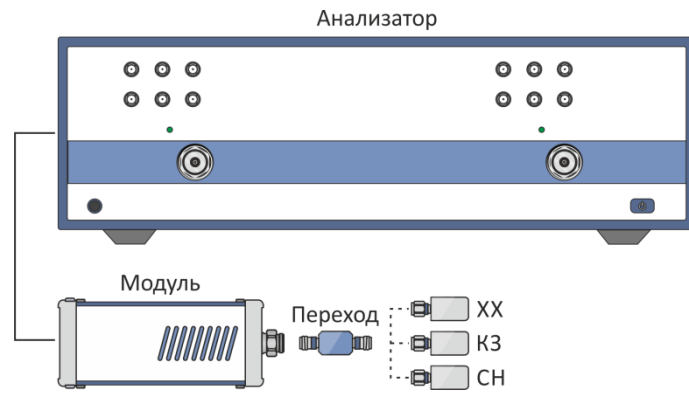
Шаг 1: Полная однопортовая калибровка первого порта
