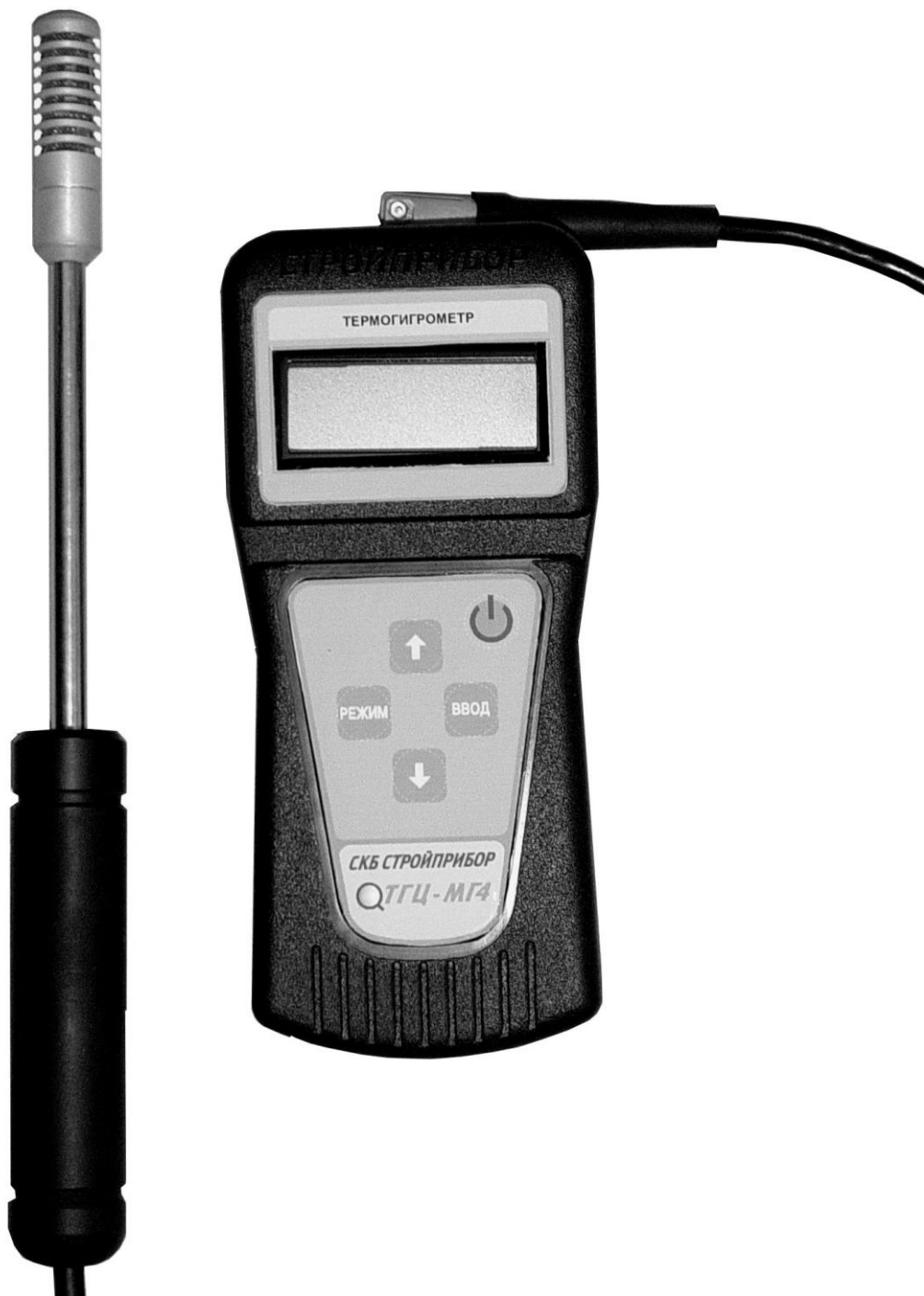
Рисунок 3.1 – Общий вид термогигрометра ТГЦ-МГ4 (ТГЦ-МГ4.01)
