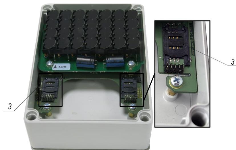
Рисунок 2.2 – Два держателя SIM карт– 3
