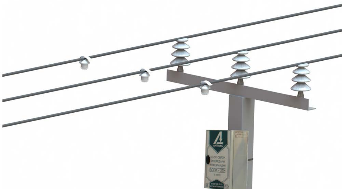
Рисунок 2 – Пример установки индикаторов ИКЗ-В34 из комплекта ИКЗ-В34-ТНЗ
