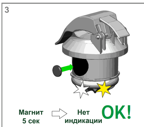
Рисунок 5 – Тестирование индикатора ИКЗ-В34Л-УЗ
