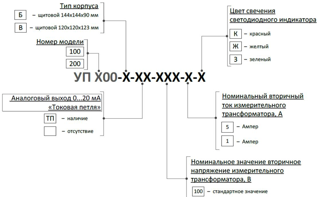
Рисунок 1 Схема обозначения моделей регулятора-указателя положения привода РПН УП 100
