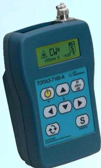
Оптические тестеры модельной группы (модификации) **ТОПАЗ-710X-AL** серии «ТОПАЗ-7000» имеют пять режимов работы и могут выполнять функции измерителя оптической мощности, источника оптического излучения, измерителя обратного отражения (ORL) и измерителя длины линии или расстояния до обрыва. В режиме «Тестер-Автомат» позволяют с помощью пары тестеров выполнить двухсторонние измерения затухания линии, возвратных потерь и длины линии для 3-х длин волн за 20 секунд.
