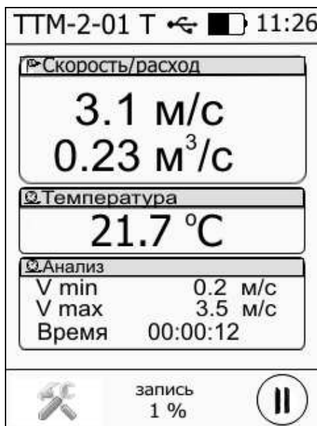
Рисунок 5.2 Экран включенных непрерывных измерений
