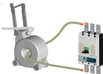
Один виток, сечение вторичной обмотки равно сечению одного токопровода
