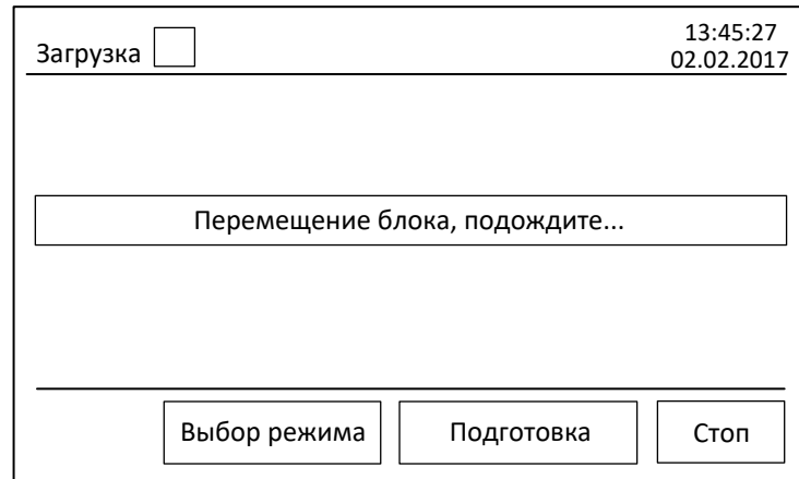
Рисунок 13 - Окно "Загрузка". Перемещение блока подготовки смеси
