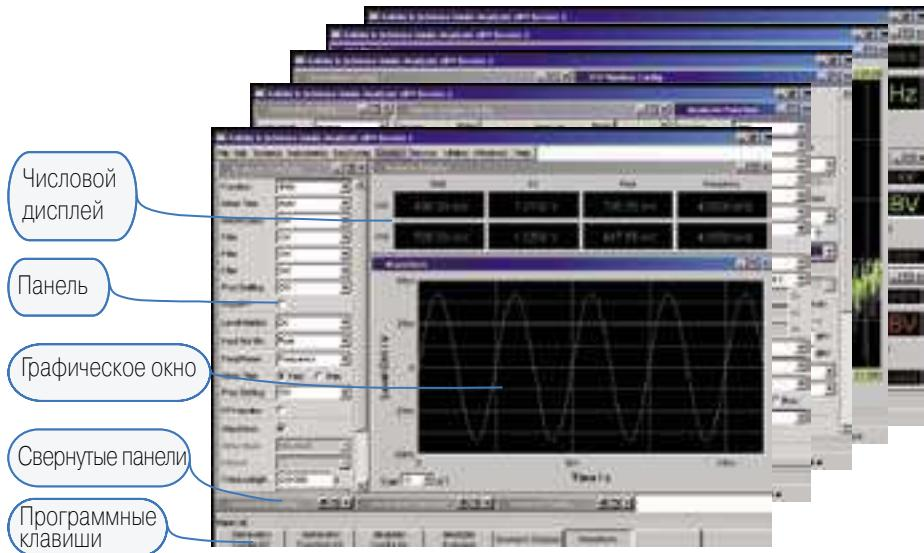
Большой экран обеспечивает одновременное отображение всех основных настроек анализатора и результатов измерений. Все многочисленные панели и окна распределены по пяти основным рабочим экранам
