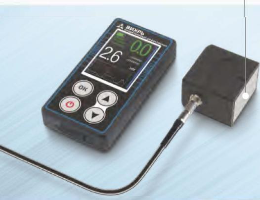
Прибор рассчитан на применение в лабораторных, цеховых и полевых условиях различных отраслей промышленности. Дефектоскоп имеет звуковую и световую сигнализацию при обнаружении дефекта и световую сигнализацию о допустимом диапазоне измеряемого покрытия.
