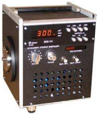
Вибростенды серии ВСВ-131М выпускаются в двух модификациях: обычное исполнение – ВСВ-131 и взрывозащищенное исполнение (ВСВ-131Ex) с маркировкой взрывозащиты "1ExibPIBT4".
