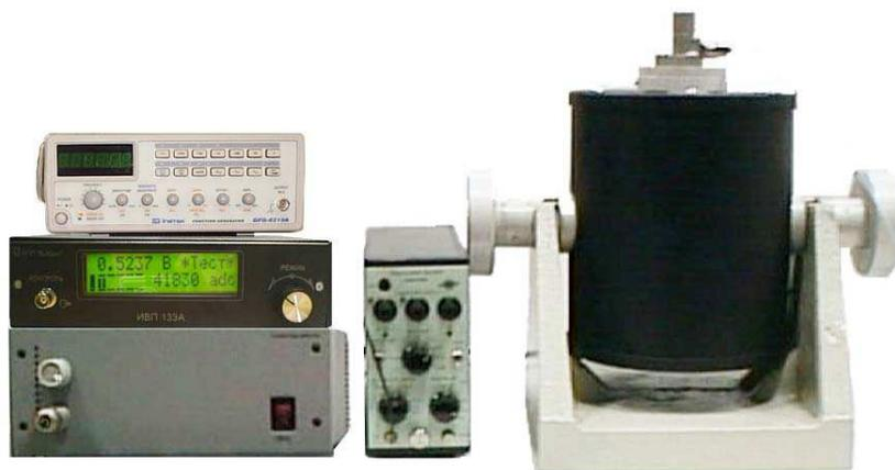
Виброустановка ВСВ-133 разработана "ВиКонт", по заказу поставляется в комплекте с лазерным интерферометром. Калибровочная электродинамическая виброустановка ВСВ-133 предназначена для воспроизведения механических колебаний синусоидальной формы в заданных диапазонах частот и амплитуд.
